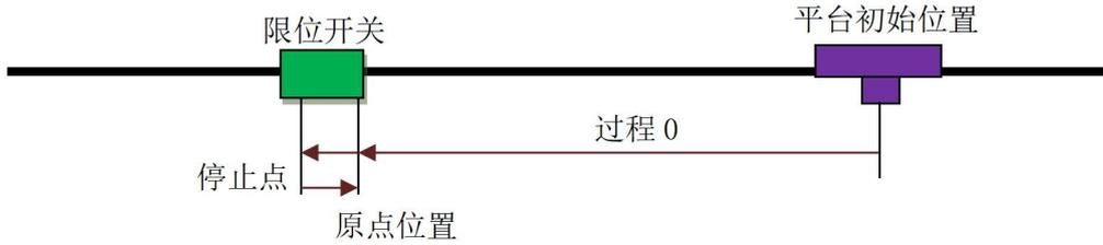
图 7.12 一次限位加回找方式示意图
