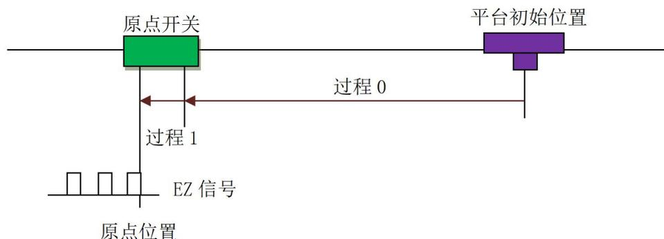
图 7.4 一次回零后再找 1 个 EZ 信号回零方式示意图
