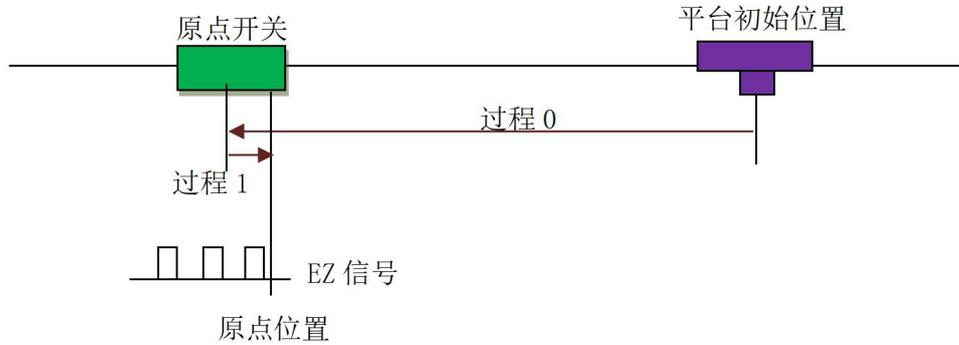
图 7.10 原点锁存加反向 EZ 锁存进行回零
